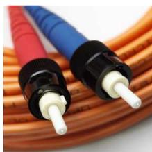
Pour relier les bâtiments nous avons pris de la fibre optique multimode, ce qui permet d'avoir de grandes distances avec un taux d'affaiblissement de 3.5db/km (contrairement au câble Ethernet qui est limité à 100 mètres de distance) ce qui est largement suffisant pour la liaison des bâtiments.
